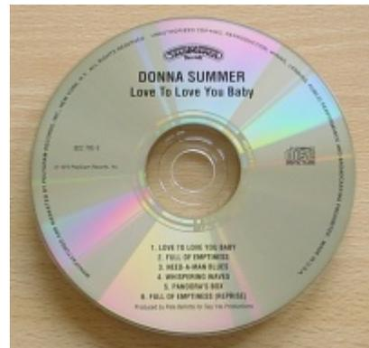
La capa metálica es reflectante y le permite al láser de la cabeza lectora leer los datos estampados. Como protección, la capa metálica se recubre con un barniz.
